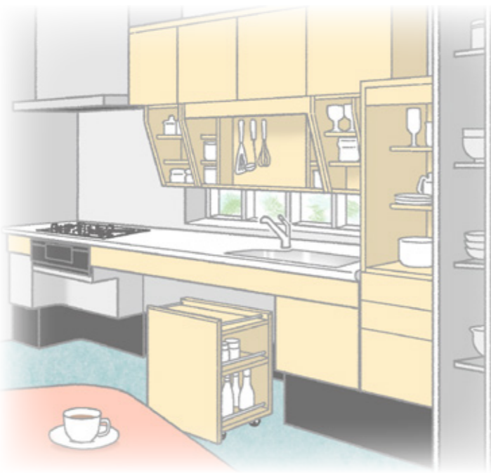
④ ボタン一つで昇降する電動収納
